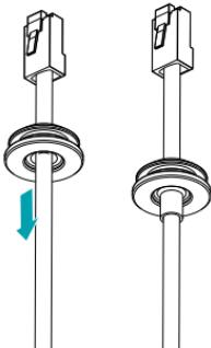
전원 및 오디오와 같은 얇은 케이블 또는 여러 갈래의 케이블을 통과시키는 경우, 원벽한 방수 처리를 위해 별도의 실리콘 마감이 필요합니다. ( 실리콘 마감 부분-하단 그림 참조)
